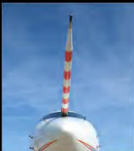
*Mit HALO können wir erstmals über weite Distanzen und aus sehr großer Höhe vertikale Profile von Wasser, Wasserdampf und Eis in der Atmosphäre messen, Wolken und Niederschlag erfassen, gleichzeitig aber auch Aerosolpartikel, um die herum sich neue Wolkentröpfchen bilden.*
