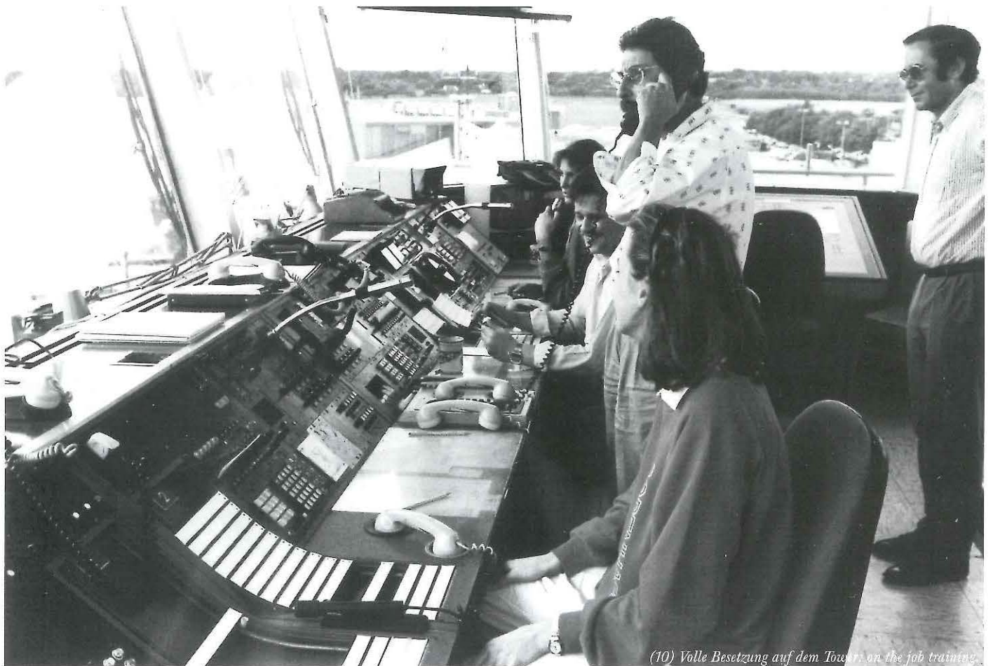
(9) Auf dieser Aufnahme von allen Tower sind allerlei technische Antiquitäten zu erkennen: links oben die Deckenlautsprecherboxen verschiedener Sprechfunk-Frequenzen, in der Mitte oben die sogenannte „light gun“ für Lichtsignale an Flugzeuge ohne Funkgerät, rechts oben die Monitore zur Überwachung des nicht einseharen Pistenanfangs 16, rechts vom Tower-Lotsen das Schaltbrett für das Stopbarren-System, ganz rechts das Lichtschaltpult für die Flugplatzbefehrerung.
