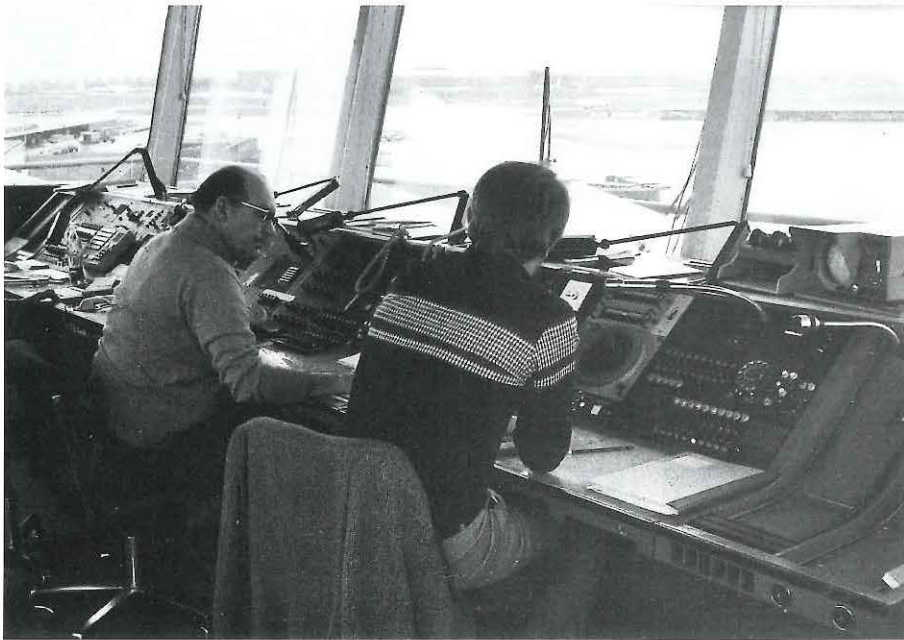
(7) Flight-Data-Assistant und Tower-Controller. Als Hilfsmittel hatte der Tower-Lotse direkt vor sich das Anzeigerät des Funkpeilers (VDF) und zu seiner Rechten das Mini-Radar (DFTI).
